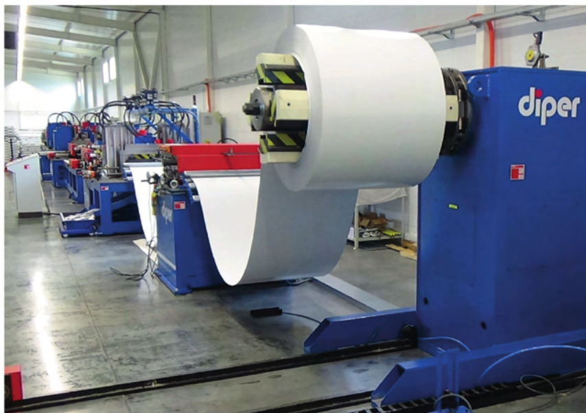
Немецкие и испанские автоматизированные линии по выпуску корпусов светодиодных светильников
